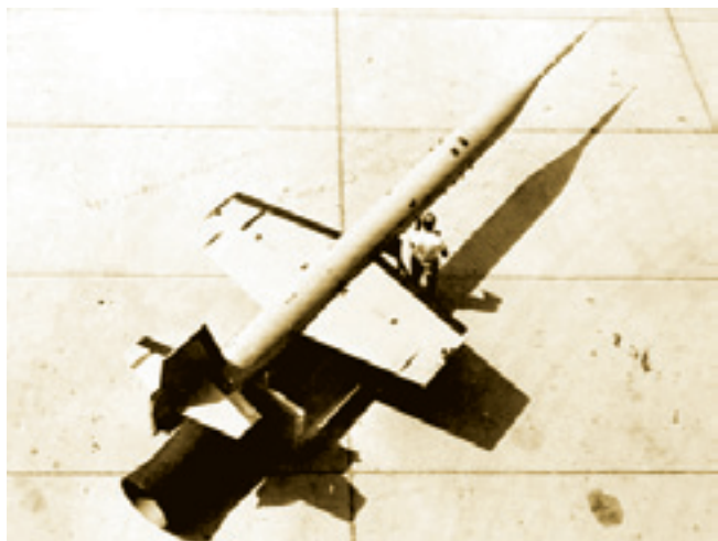
Экспериментальный аппарат X-7 мог развивать скорость до 4640 км/ч. Его можно считать предшественником F-104
